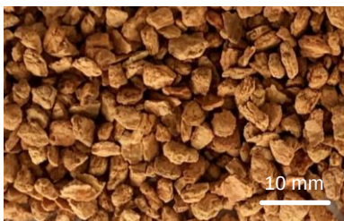
세부제품명 가공 코르크 칩 【4호】 내추럴 제 품 코 드 FCP-N-04 제 품 규 격 2-4 mm 제 품 색 상 내추럴 제 품 용 도 코르크 바닥 포장재 상부층 설치 등
